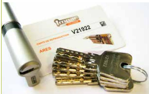
En option sur toutes nos portes, nous vous proposons un cylindre de sécurité à 10 goupilles, livré avec 5 clés réversibles et une carte nécessaire à toute reproduction de clé. Il est également débrayable, ce qui signifie qu'il peut être manœuvré d'un côté même si la clé a été laissée de l'autre côté. Enfin, ce cylindre est conforme à la norme EN 1303 (classification 150B0C5D).
