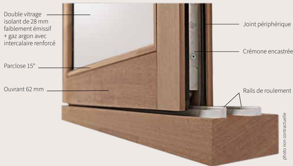
La performance  $U_w$  représente la capacité d'une menuiserie à conserver la chaleur de la fenêtre entière. La performance AEV désigne la résistance de la menuiserie aux éléments Air/Eau/Vent. Calcul réalisé sur une base de dimensions conventionnelles de fenêtre 2 vantaux en double vitrage 4/20/4 ( $U_g : 1.1$ ).
